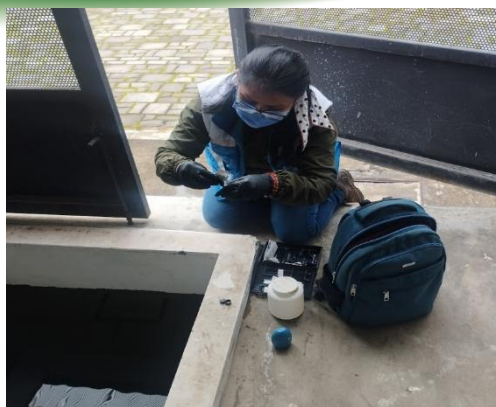
Comprobación de Cloro y toma de muestra de Agua-Cisterna Hospital Básico de Sigchos
